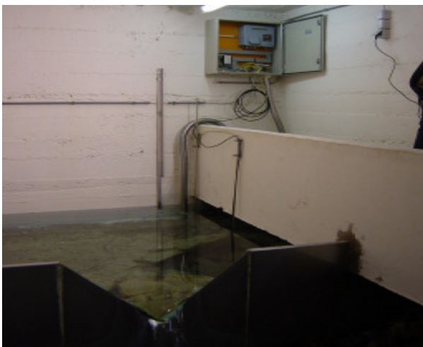
Abbildung 4: Geräteanordnung am Quellaustritt
